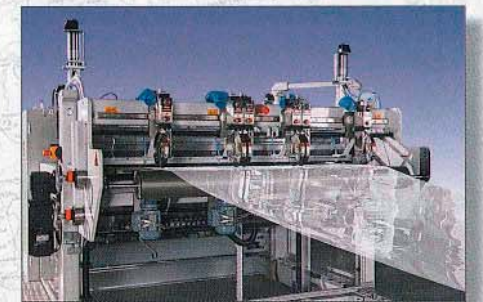
Randbesäumung horizontal & Mehrfach-Längsschnitt
